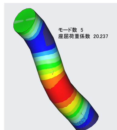
図 2 支柱の座屈解析による解析結果
