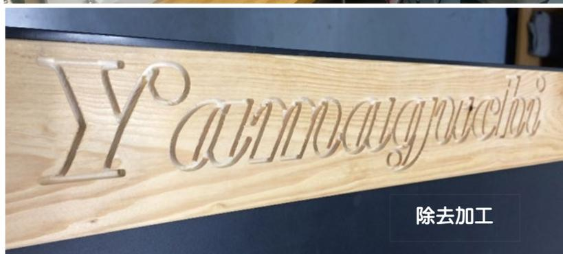
産業用ロボットに、イラストレータで描いたアウトラインフォントを加工させてみました。
