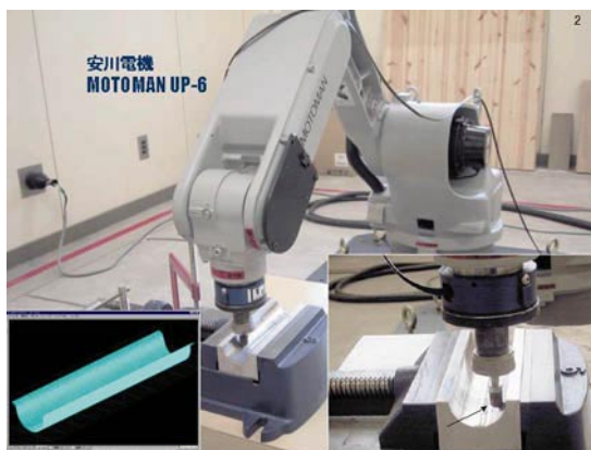
図2 金型磨きロボットによるブロー成型用金型の磨き風景 (株式会社メイホー：直方市)
