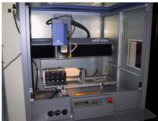
図3 円筒形ワークのための3次元加工システム (株式会社フクモト工業：鞍手郡)
