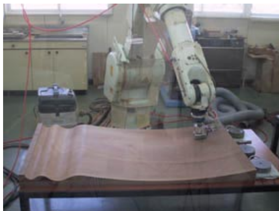
図1 ロボットサンダーによる大型曲面ワークの研磨風景 (インテリア研究所：大川市)
