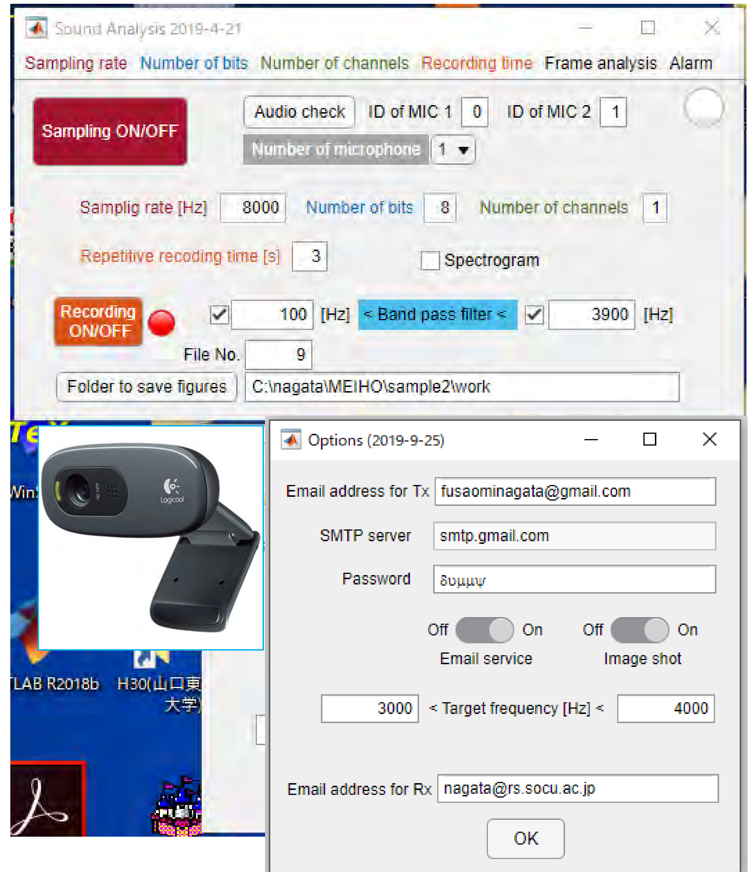
図3 周波数解析とIoT技術を用いた異常検出&通知システム
