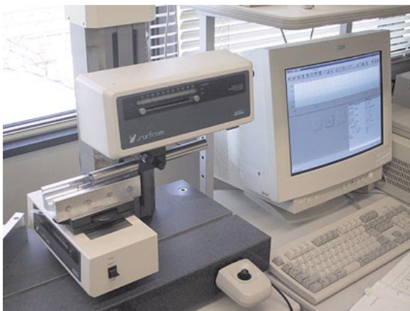
図-4 表面粗さ測定器SURFCOM-1400
