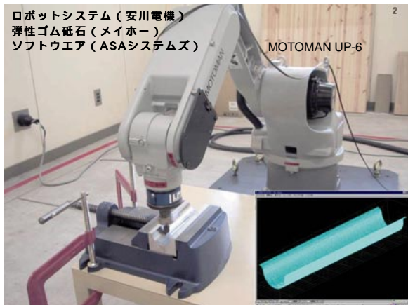
図-3 開発した磨きシステムによる磨き風景
